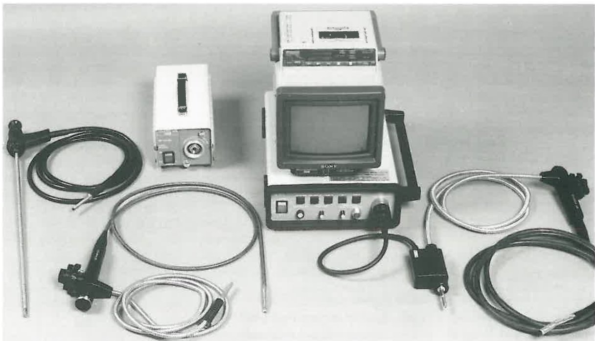
Till vänster ett stelt boroskop, i mitten ett flexibelt fiberskop och till höger ett videoendoskop.
